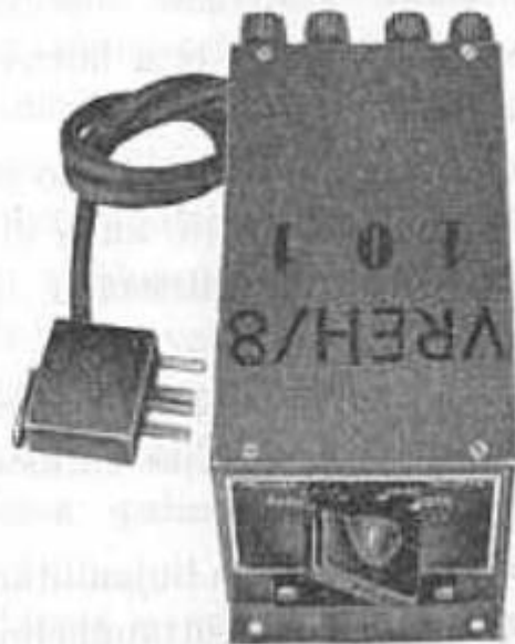
Kuva 3. VREH: linjanliitännälaitte VREH/8.
