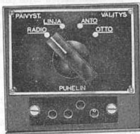
Kuva 4. VREH: linjanliitännälaitteen etulevy.
